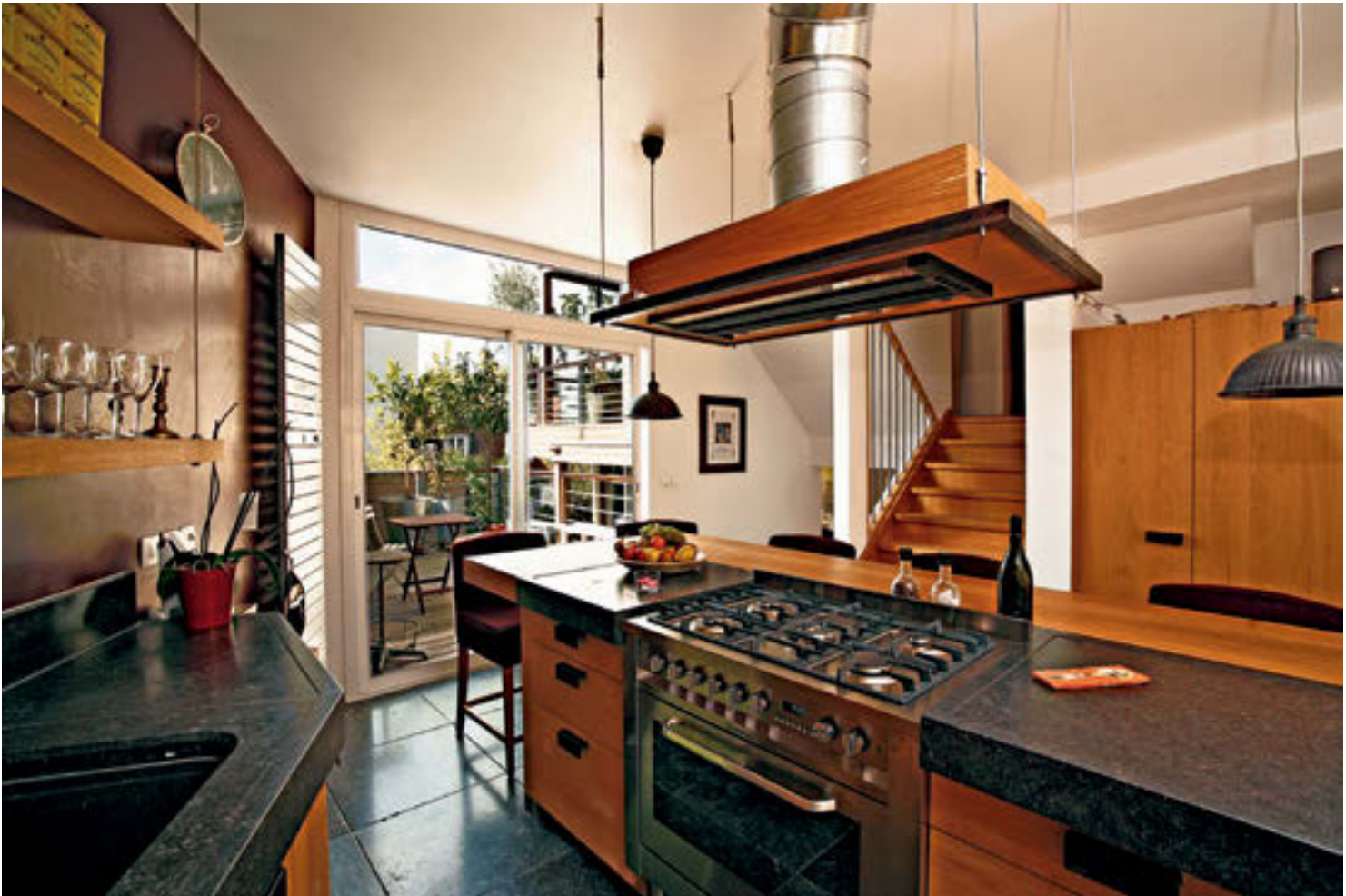
La cuisine a été fabriquée sur-mesure par Xavie'z. Les plans de travail sont en pierre bleue de Belgique et les placards en chêne. Comme il était difficile de réaliser de manière discrète le conduit de la hotte, les propriétaires ont opté pour un tuyau massif qui fait partie intégrante de la décoration.
